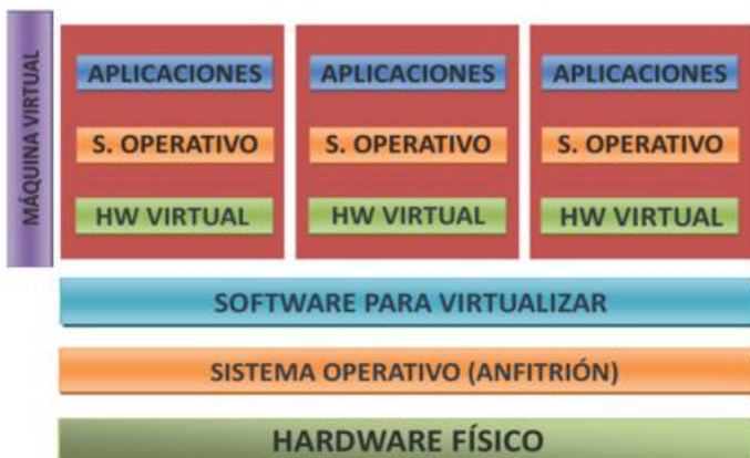
Imagen 2. Esquema de virtualización de host
