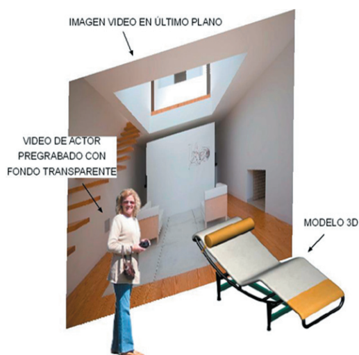
Fig. 1. Ejemplo de sándwich de elementos que utiliza la realidad aumentada en 3D
