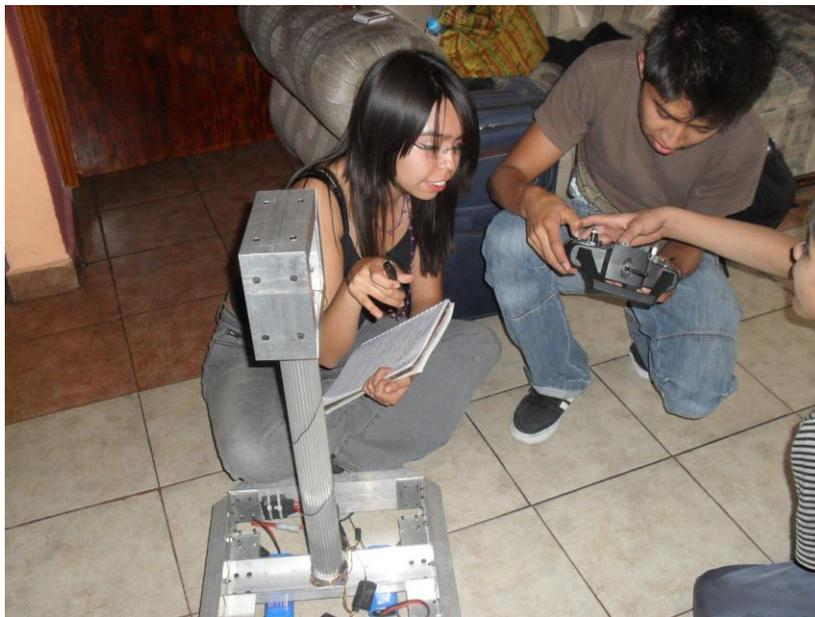
Con una especie de "poste" se conecta la base con un sistema Pan-Tilt situado más arriba, a unos 50 cms de la base. Este sistema permite, a manera de cadera, girar e inclinarse a la parte superior.
