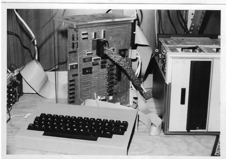
Figura 5: Uno de los procesadores LISP de la AHR
